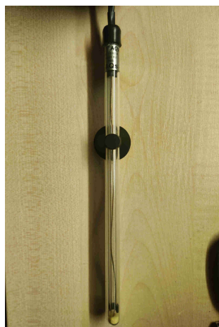
Rysunek 5.2 Grzałka wykorzystana podczas testów
