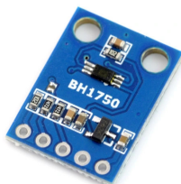
Rysunek 2.7 Czujnik natężenia światła BH1750 [4]
