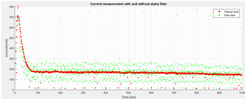
Rysunek 2: Wykres porównujący dane pomiaru prądu przed i po filtracji
